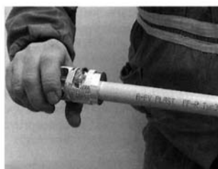
рис. 36: У труб STABI нужно удалить, с помощью трубореза, верхние пластовый и алюминиевый слой. Полученная таким образом пластиковая труба будет иметь гладкую поверхность и соответствующие размеры, отвечающие требованиям для диффузионного сваривания.
